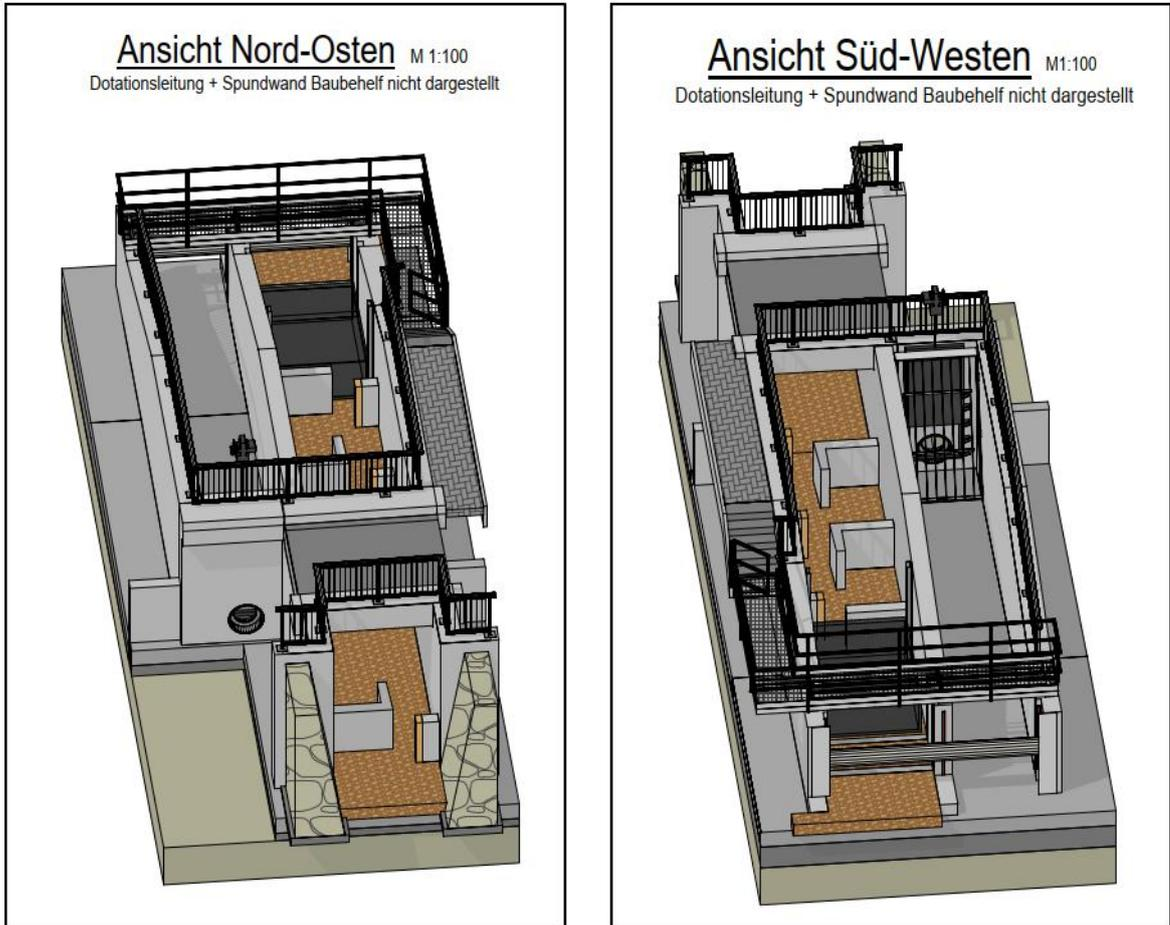
Abbildung 24: Isometrie Ausstiegsbauwerk
