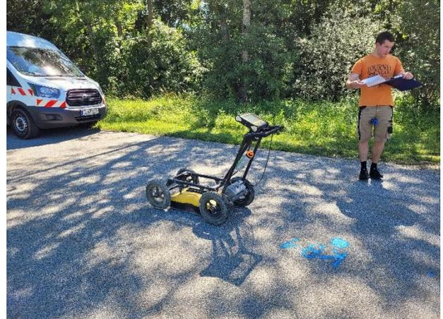
*Messung des Bohransatzpunktes mittels Georadar*
