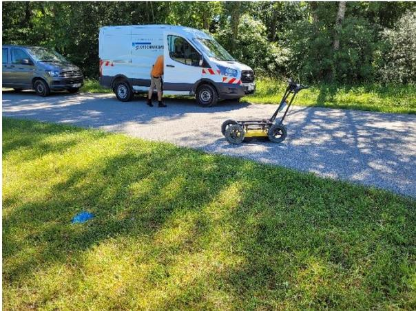
*Messung des Bohransatzpunktes mittels Georadar*
