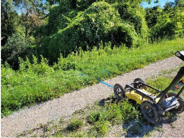
**Messung des Bohransatzpunktes mittels Georadar**
