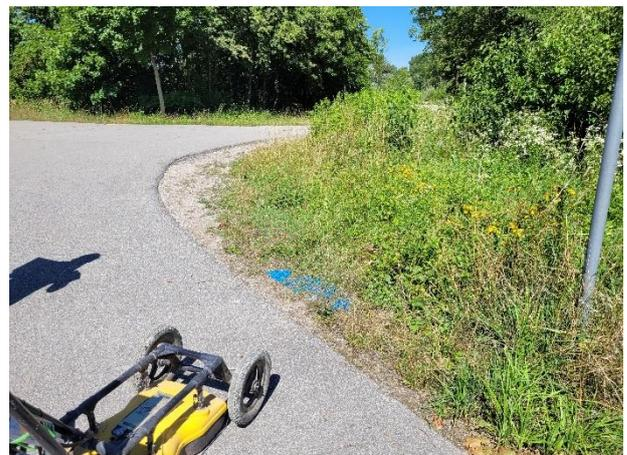
*Messung des Bohransatzpunktes mittels Georadar*
