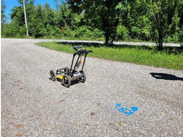
*Messung des Bohransatzpunktes mittels Georadar*
