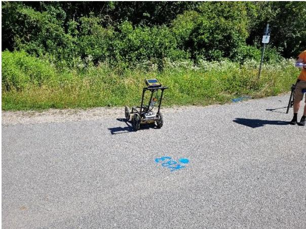
*Messung des Bohransatzpunktes mittels Georadar*
