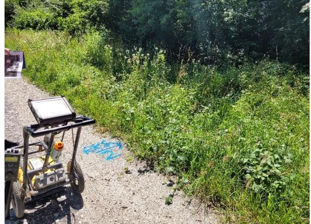
*Messung des Bohransatzpunktes mittels Georadar*
