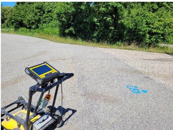
*Messung des Bohransatzpunktes mittels Georadar*
