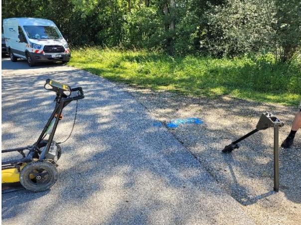
*Messung des Bohransatzpunktes mittels Georadar*
