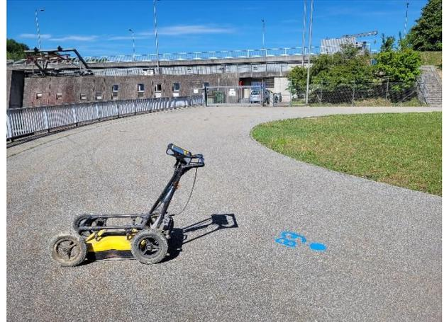
**Messung des Bohransatzpunktes mittels Georadar**
