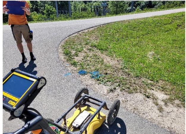
*Messung des Bohransatzpunktes mittels Georadar*
