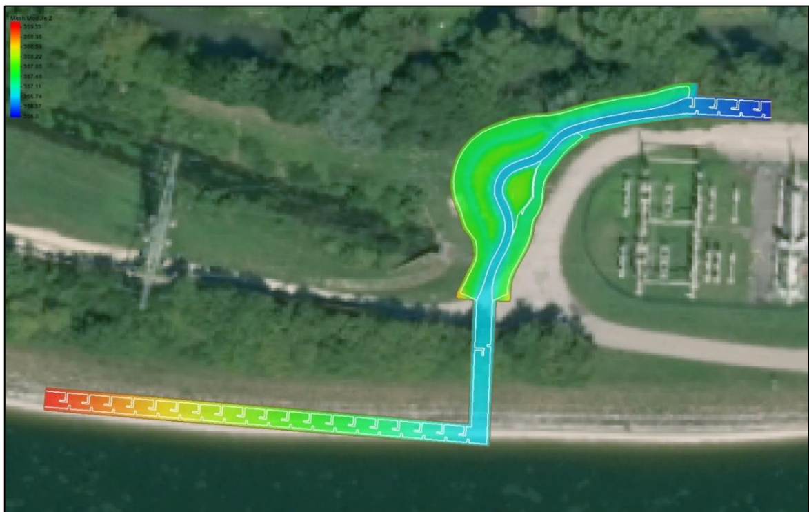
Abbildung 7: Modellumgriff OW Ausstieg und Raugerinne mit Flachwasserzonen
