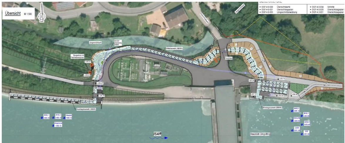
Abbildung 6: Übersichtslageplan Fischaufstiegsanlage Dingolfing
